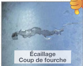
Photos 64 et 65 : Les conséquences d'un mauvais colisage
