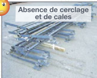
Photos 62 et 63 : Mauvais colisages
