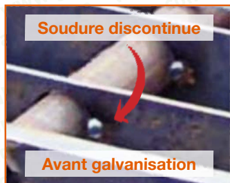
Photos 48 et 49 : Les défauts de soudures discontinues
