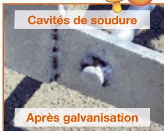
Photos 48 et 49 : Les défauts de soudures discontinues
