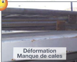
Photos 64 et 65 : Les conséquences d'un mauvais colisage
